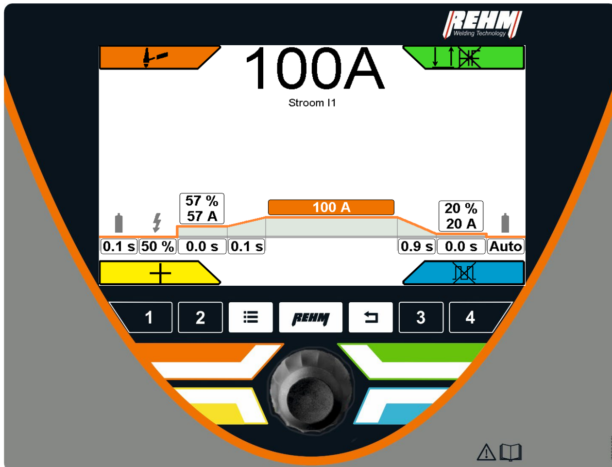
Figura 5: Elemento di comando e schermata principale INVERTIG 450 i
